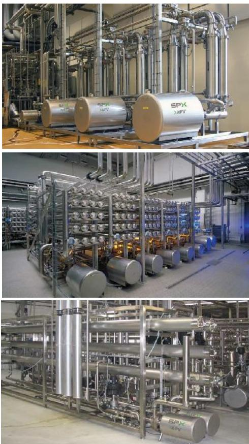
Мембранные фильтрации с применением спиральных и пластинчатых мембран для получения максимально возможного остатка сухих веществ. Мембранные технологии – это испытанный метод разделения, осуществляется на молекулярном и ионном уровнях. За сорок лет эта технология была адаптирована применительно для молочной промышленности. В молочной промышленности мембранные технологии главным образом ассоциируются со следующими технологическими процессами:
